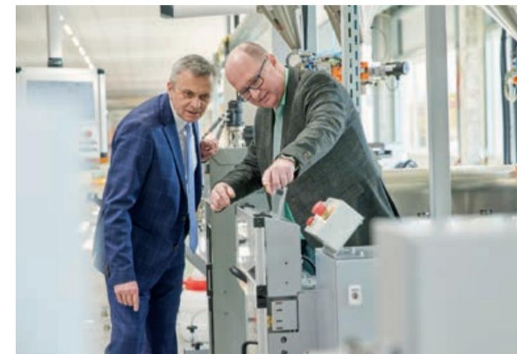
**Die Produktionsgeschwindigkeit der neuen, hochmodernen Kabelfertigungsanlage in Bruchsal ist enorm. Eine Einzelader in der Stärke von 1 mm<sup>2</sup> kann mit bis zu 1.000 m/min ummantelt werden.**
