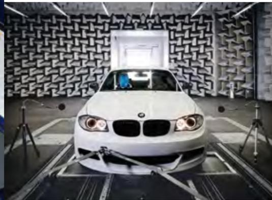
Prüfzelle für Geräusch-, Schwingungs- und Rauigkeitsmessungen inkl. Prüfstand bei der AVL Zöllner GmbH.
